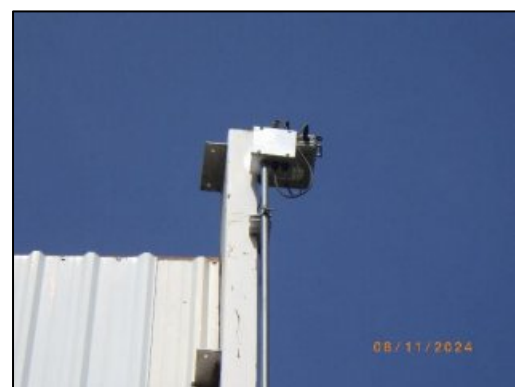
รูปที่ 2-23 เครื่องมือติดตามตรวจสอบคุณภาพอากาศความเร็วลมและทิศทางลมอัตโนมัติ
